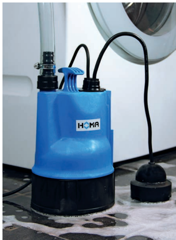
C237 WF3: Automatische Einschaltung ab einem Wasserstand von 5 mm - Restabsaugung bis auf 2 mm.
