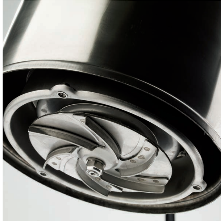
CR 360 - 374V: Das Vortex-Laufrad fördert Feststoffe bis 30 mm Durchmesser.
