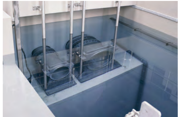
Im modernen Prüfzentrum werden die Aggregate vor der Auslieferung getestet. Dies garantiert die bekannte HOMA Qualität.
